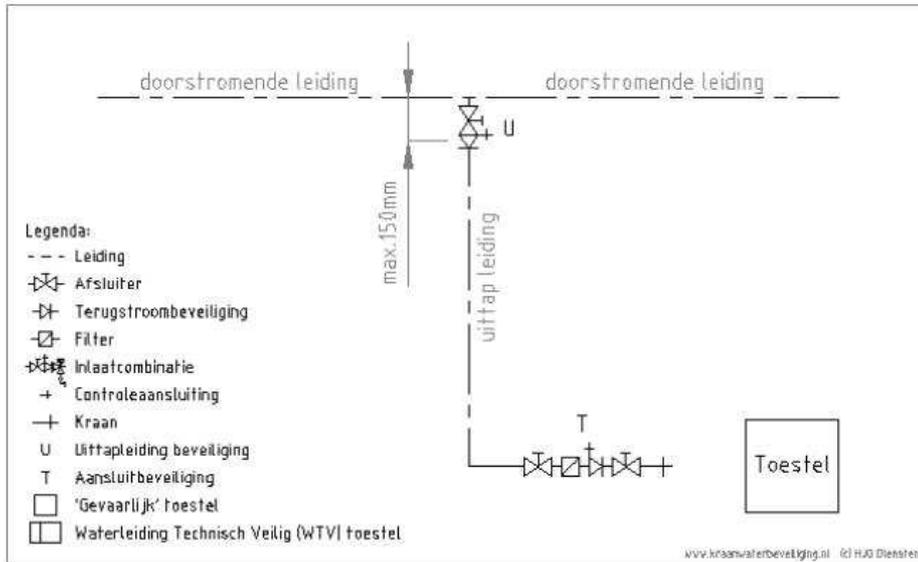
Aansluiting van melkseparatie met dosering vloeistofklasse 4.
