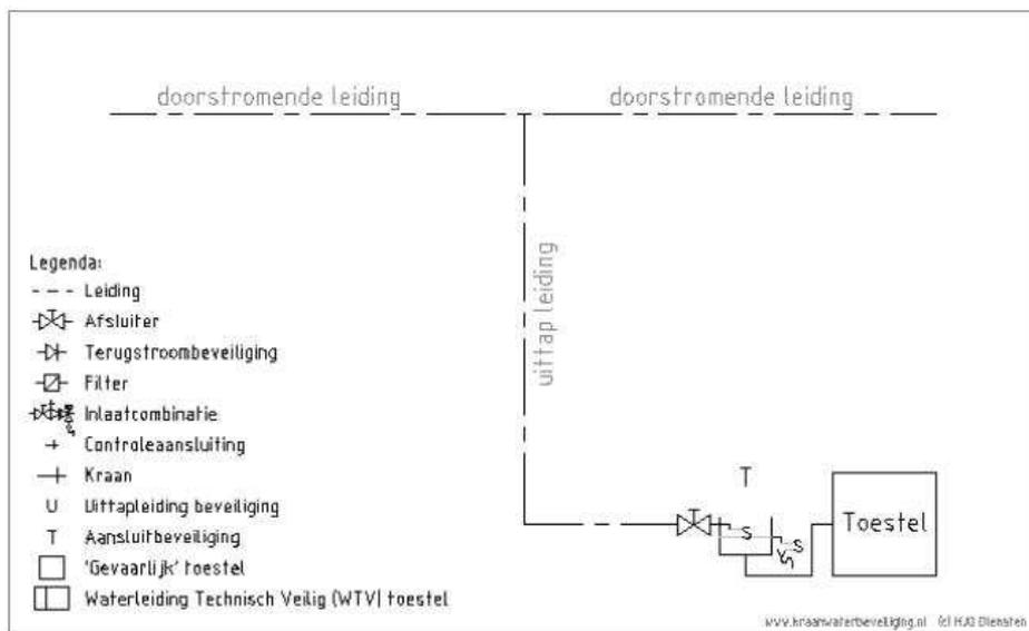
Aansluiting van een melkfilter en contact met melk.
