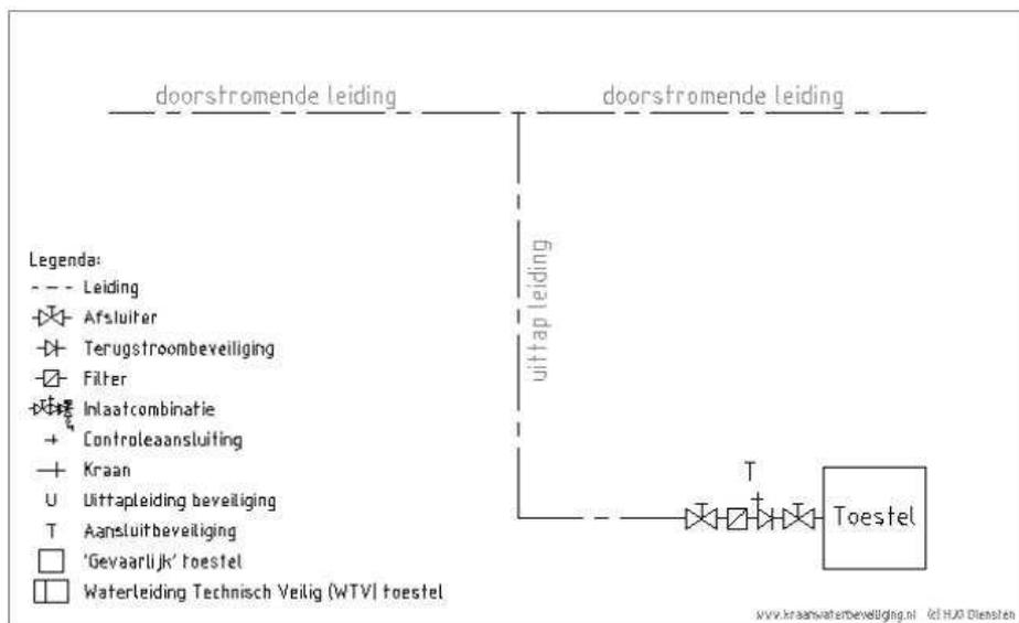
Aansluiting van een toiletbril reiniger als deze rechtstreeks op de waterleiding is aangesloten.
