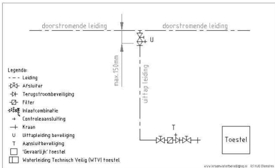
Kraan voor het vullen van Gekoeld Watersystemen met drinkwater. Met een toegevoegd middel met een onbekende LD50 waarde.
