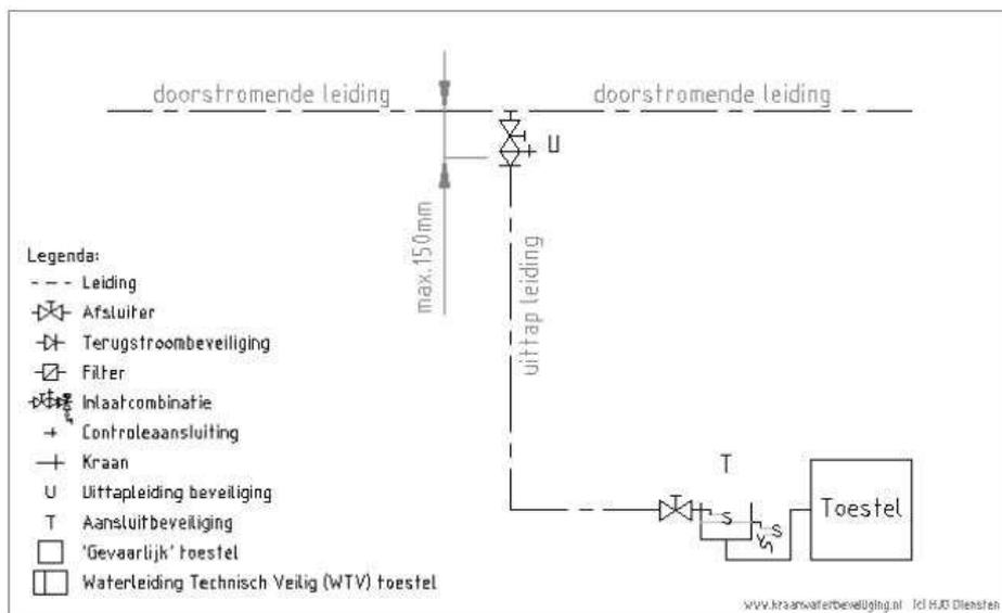
Aansluiting van een bootlift installatie. De bootlift installatie is niet voorzien van een vrije uitloop met injector (AD) of de beveiliging is onbekend.
